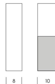
L'épaisseur du verre est de 8 millimètres pour les versions entièrement en verre de HÜPPE Sphere. Pour les modèles combinant des modules en verre et en matériau minéral, l'épaisseur est portée à 10 millimètres.
