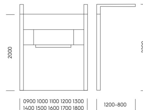
HÜPPE Sphere est disponible en plusieurs dimensions pour s'adapter à tous les projets. Huit longueurs standard, de 900 à 1.800 millimètres. Barre transversale standard de 1.200 millimètres, ajustable sur place jusqu'à 800 millimètres. Hauteurs au choix: 2.000 ou 2.200 millimètres. Pour répondre aux exigences spécifiques, des fabrications sur mesure sont également possibles sur demande.
