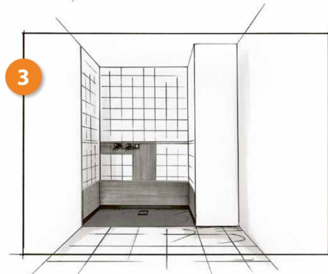
Setzen Sie die neue Duschfläche inklusive Dichtband ein.
