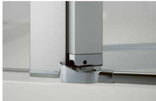
Der kraftvolle Hebesenkmechanismus hebt die Tür beim Öffnen leicht an und sorgt für einen satten Türschluss. Nebenbei beugt diese Funktion dem Verschleiß der unteren Dichtleisten vor.
