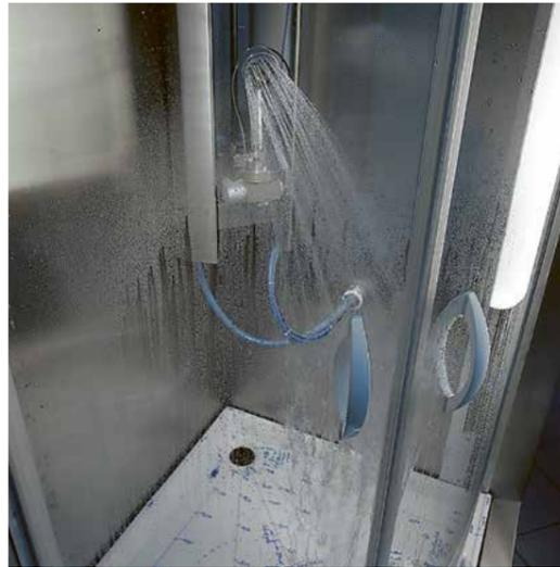
Zur Prüfung der Funktionssicherheit werden die Türsysteme aller HÜPPE Duschkabinen mindestens 30.000-mal nonstop getestet – statt der gesetzlich vorgeschriebenen 20.000 Mal.
