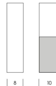
Die Glasstärke beträgt bei den Vollglasvarianten von HÜPPE Sphere acht Millimeter. Bei Modellen, die Glas- und Mineralwerkstoffmodule kombinieren, misst sie zehn Millimeter.
