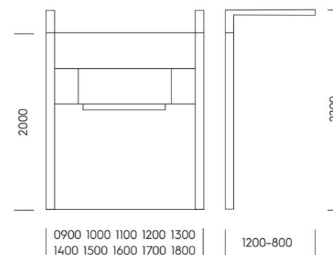
HÜPPE Sphere ist in verschiedenen Abmessungen erhältlich. Es gibt acht unterschiedliche Standardlängen zwischen 900 und 1.800 Millimetern. Der Standard-Querbügel wird mit einer Breite von 1.200 Millimetern geliefert; er kann vor Ort auf eine Breite von bis zu 800 Millimetern gekürzt werden. Die Höhe bemisst sich auf 2.000 oder 2.200 Millimetern. Maßanfertigungen sind auf Anfrage möglich.
